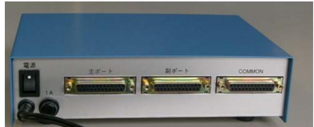
本装置はRS232Cの切替えスイッチで主ポートに接続された装置に何らかの通信障害が発生した時に強制切替スイッチによる切替えもしくは副ポートに接続された装置の立ち上がりにより副ポート側に自動切換えする装置です。
