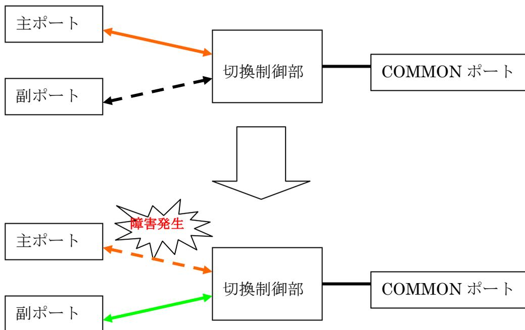
副ポート側に接続された機器からの制御信号 (DSR、CD、DTRより選択) 又は強制切換スイッチにより回線を副ポートに切換えます。
